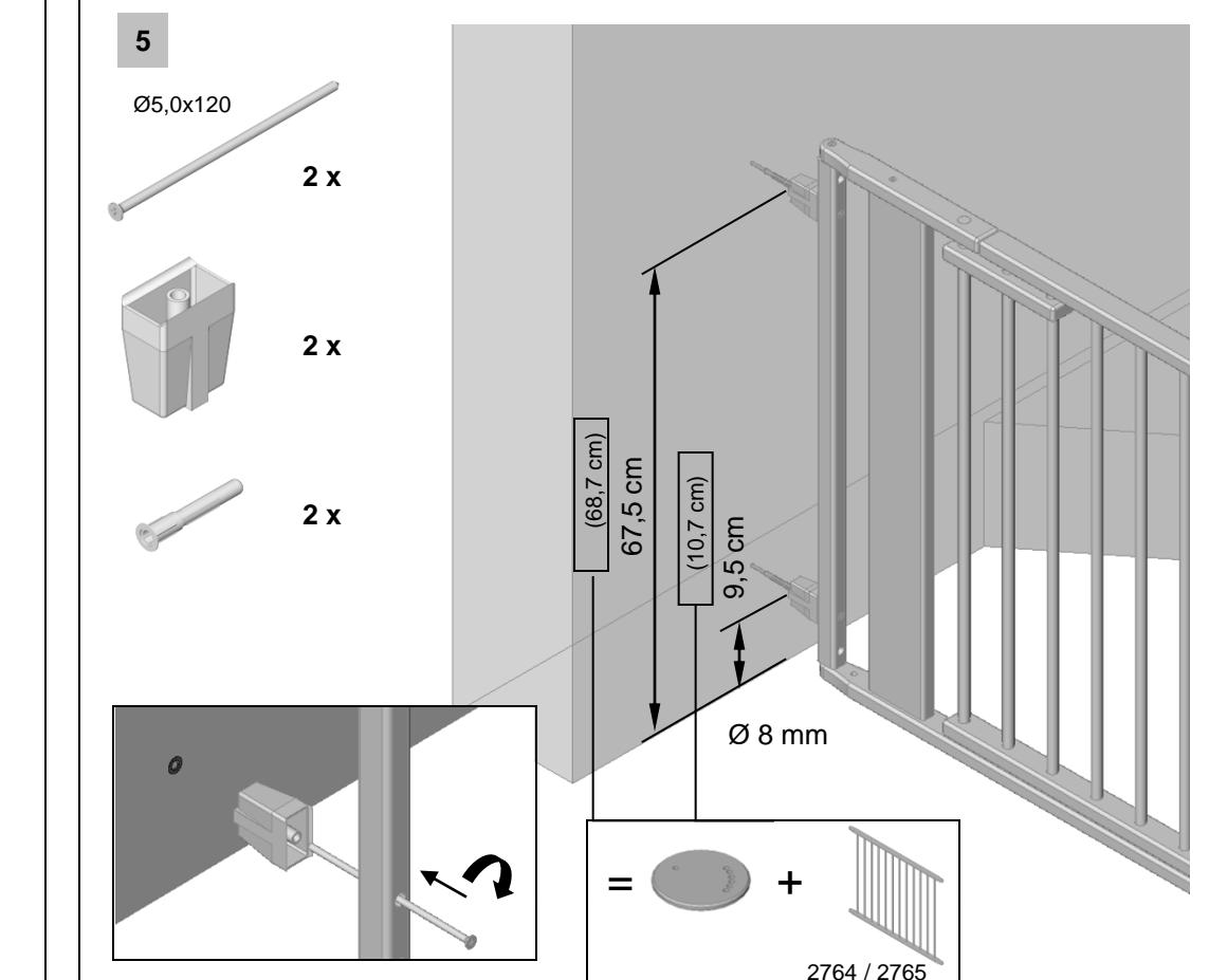
**DE** Markieren Sie bitte die beiden Dübelbohrungen und schrauben Sie eine Seite des Gitters fest. Bei festem Mauerwerk eignet sich der mitgelieferte Dübel. Für Trockenbauwände oder Porenbeton verwenden Sie bitte Spezialdübel aus dem Fachhandel.
