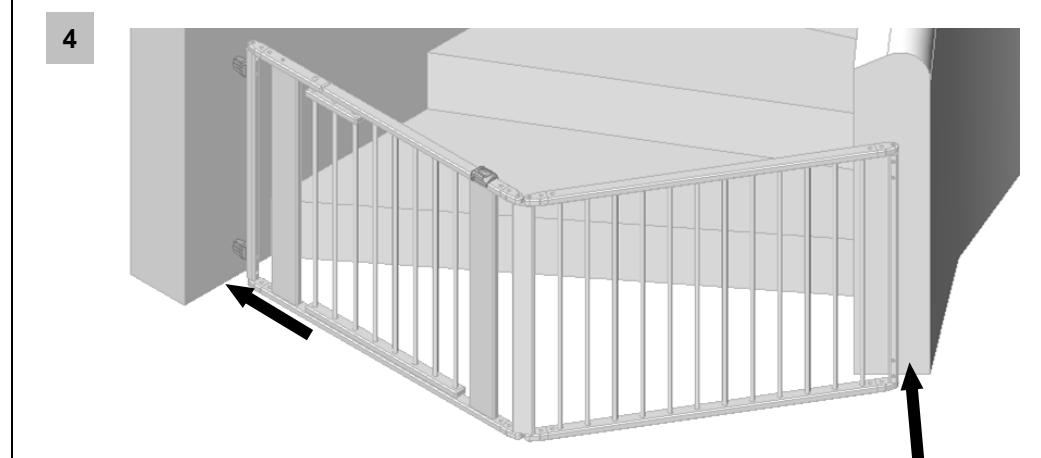
**DE** Stecken Sie das Gitter zusammen und richten Sie es an der zu schützenden Öffnung oder Treppe aus. Beachten Sie bitte das das Gitter nie in einer geraden Linie aufgebaut werden darf. Bei Treppen Auf- und Abgängen muss der Abstand zur ersten Stufe mindestens 40cm betragen.
